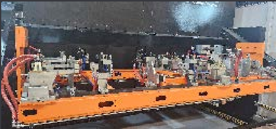
Dispositivos de punteo manual previos a soldadura robotizada - Estructura de fumigador
