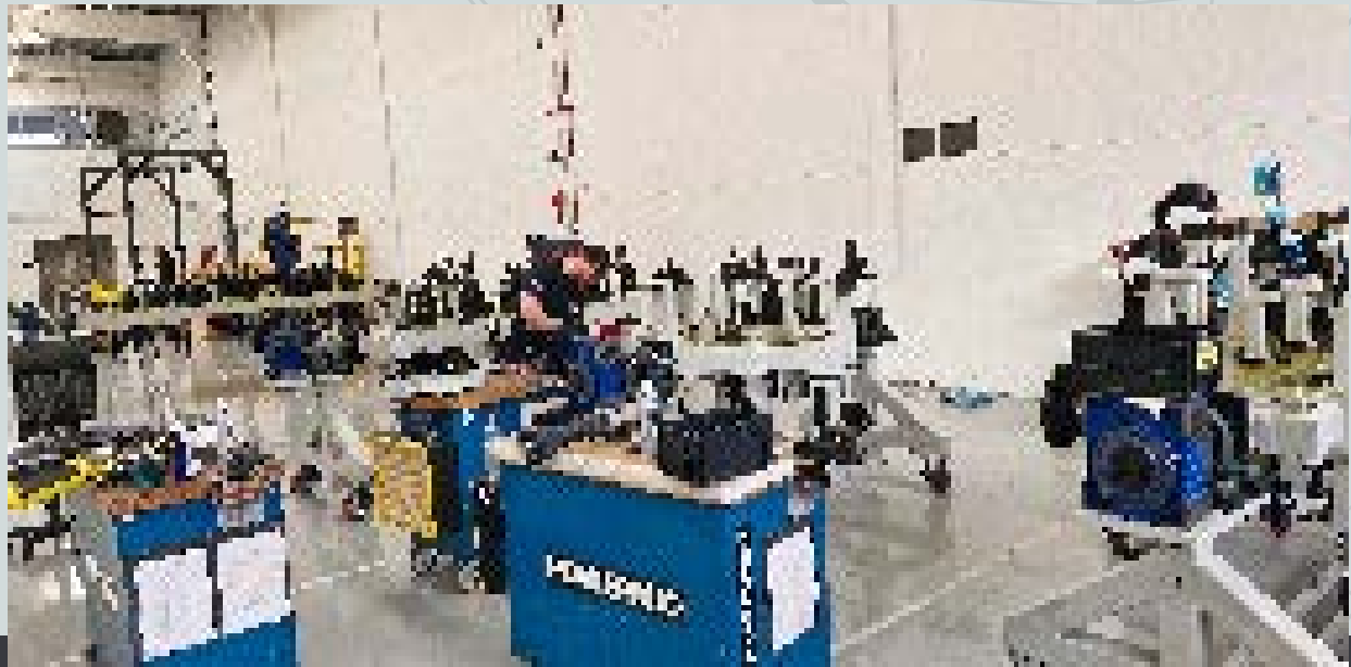
Dispositivos de punteo manual previos a soldadura robotizada - Estructura de fumigador
